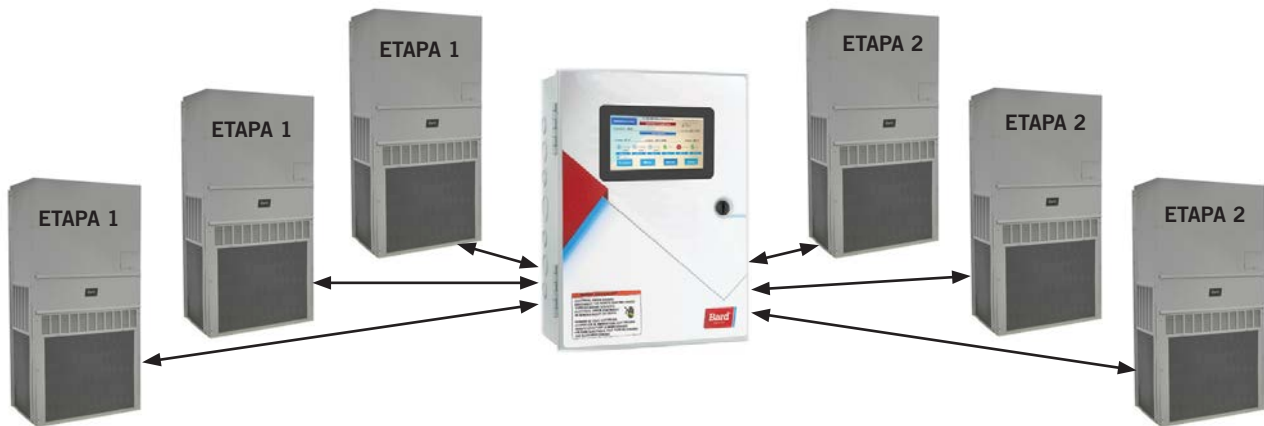
FIGURA 15 Hermanamiento triple: operación simultánea de unidades
