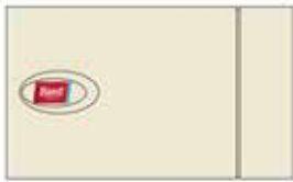
Zona 1: Sensor remoto de temperatura opcional, bornes 20 y 21*
