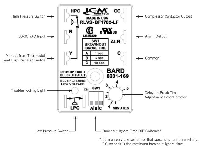
FIGURE 9 8201-169 Compressor Control Module
